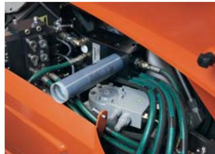
An der Seite der Maschine befindet sich eine Klappe. Auf der Innenseite können Filter, elektrische Komponenten und Öl gewechselt oder eine Fehlersuche vorgenommen werden. Hydraulikschläuche haben Steckverbindungen, um das Wechseln von Schläuchen zu vereinfachen.
